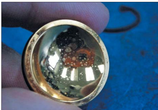
Загрязнение зеркала оптической камеры моющим агентом
