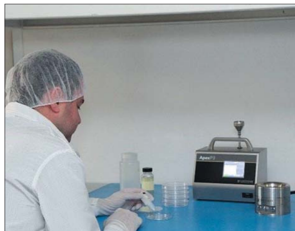
Счетчик частиц с короткой пробоотборной трубкой в ламинарном боксе. Отбор проб в рабочей зоне
